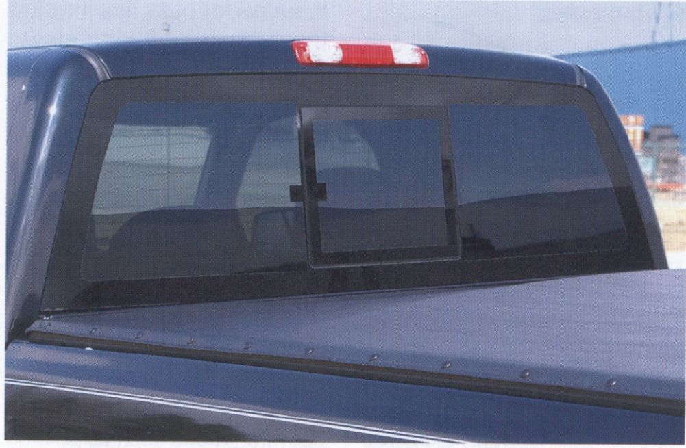
Resim Yazısı 2: Guardian Endüstrileri'nin yenilikçi düz montajlı sürgülü pencereleri, ray ve Rynite® PET'den kalıplanmış bir merkez cam taşıyıcısı ile düşük sürtünmeli Delrin®'den yapılan kılavuzları kullanmaktadır.
