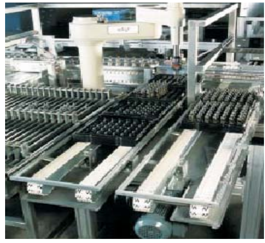
Şekil 2. Yakıt Enjektörü Montaj Hattı [1]
