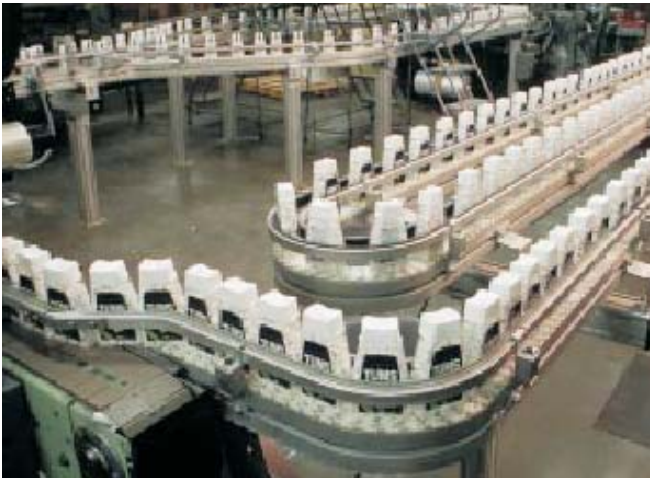
Şekil 1. İlaç Fabrikasında Şişe Dolum Hattı [1]
