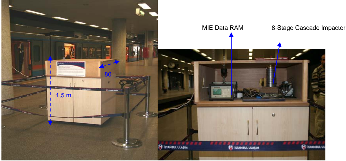
Şekil 1. İstasyon Peronlarına yerleştirilen PM ölçüm platformu.
