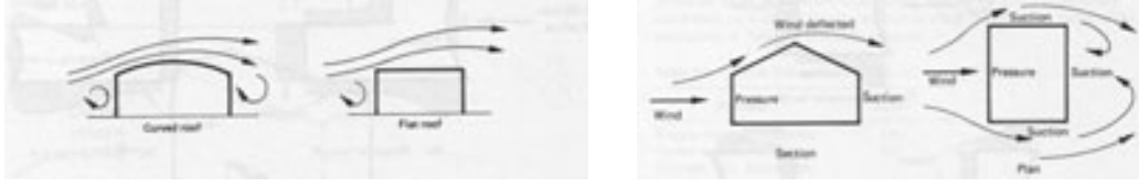
Şekil 11. Bina çatılarının biçimlenişine bağlı girdap oluşumu
