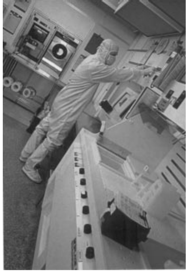
MEMS sensörleri alıcıya gönderilmeden önce, steril bir laboratuvar ortamında sıvıya daldırma, basınçlı değiştirme ve diğer testlere tabi tutulmaktadır.
