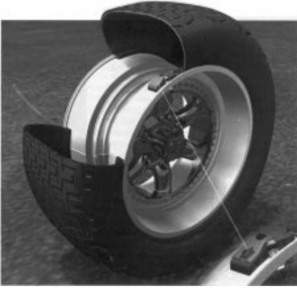
Tipik olarak, bir tekerlek basıncı algılama modülü tekerin jantına yerleştirilmekte. MEMS paketi titreşim, ısı ve korozif akışkanlara dayanıklı olmalıdır.
