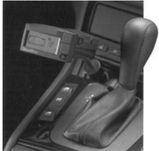
Bir tekerlek basınç algılama göstergesi, bir binek otomobilinin her bir tekerine yerleştirilmiş basınç sensörü tabanlı sayısal basınç okumalarını vermektedir.
