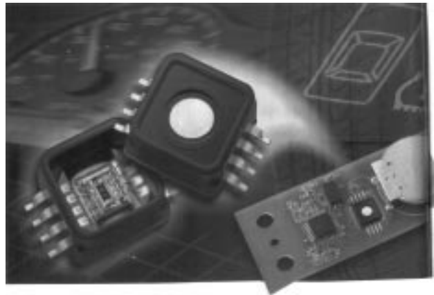
Freescale Semiconductor tekerlek basıncı izlenmesi için bir kapasitif basınç sensörü sunmaktadır. Bazı sensör firmaları kapasitif sensörlerin pilin gücünü korumasına yardımcı olduğunu iddia etmektedir.
