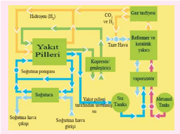
Şekil 12. Sıvı Metanolün Yakıt Olarak Kullanıldığı Bir Yakıt Pili Motor Diyagramı [12].
