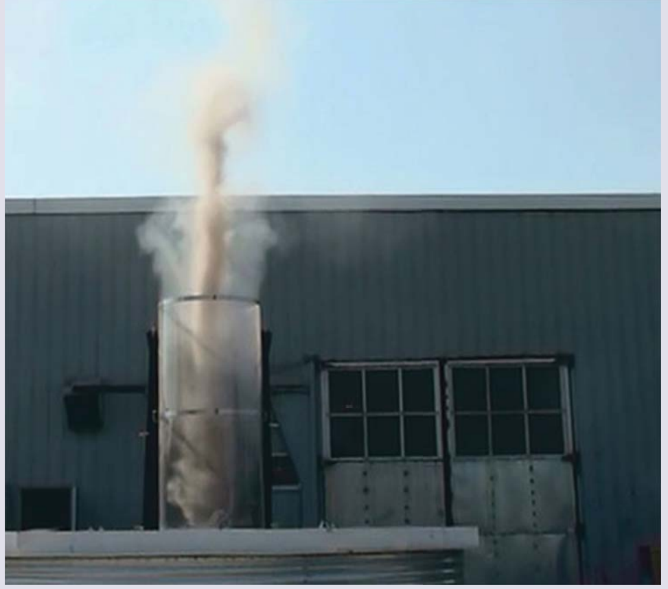
Silindirin ısıtılan havayla teğet biçimde beslenmesi, deney sırasında minik bir hortum yaratılmasını sağladı.
