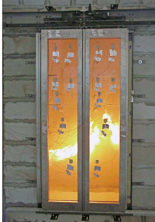
Şekil 1: Asansör Kat Kapısı Yangın Testi
