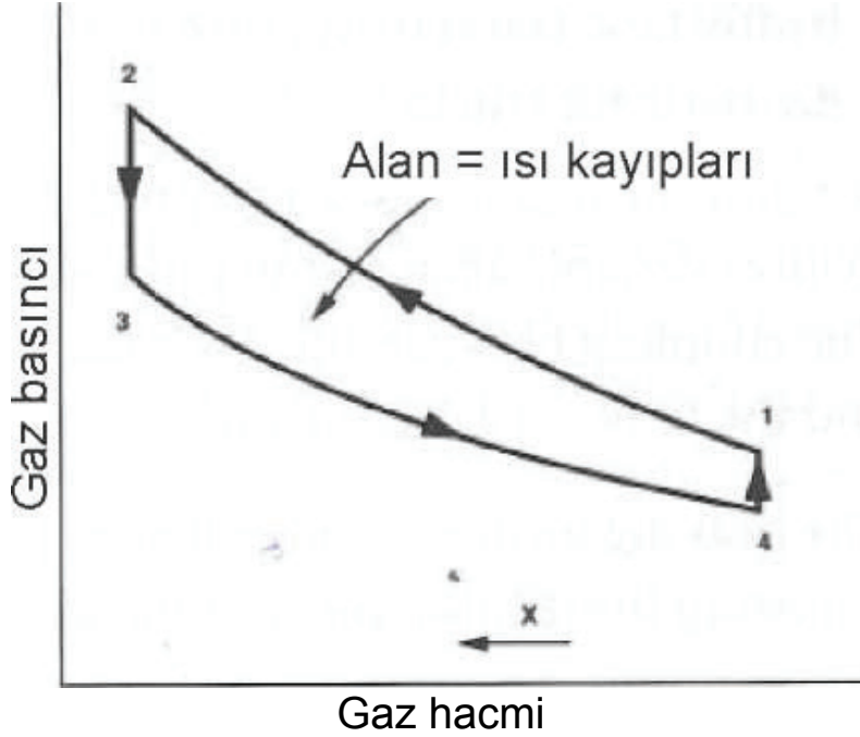
Şekil 3. Hidrolik Diyaframlı Akümülatörün Dolma / Boşalma Süreci.
