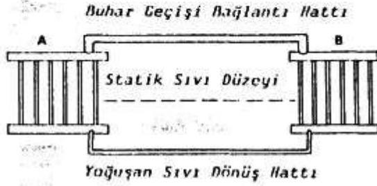
Şekil 13. İki Yönlü Isı Transfer Eden Serpantinli Termosifon Devresi (Isı A' dan B' ye ve B' den İki Yönlü Transfer Edilebilir).
