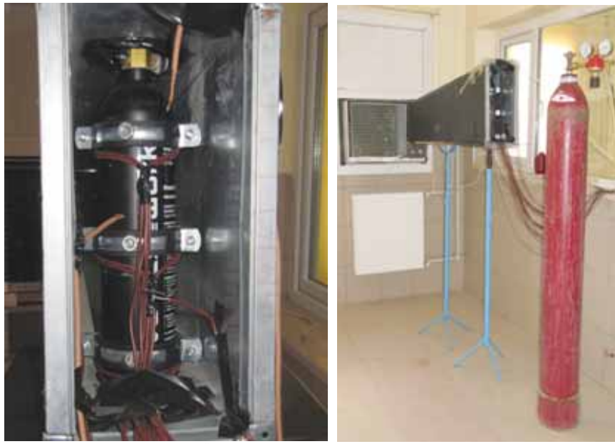
Şekil 2. Isıtma-Soğutma Kontrol Ünitesi ve Kanalı
