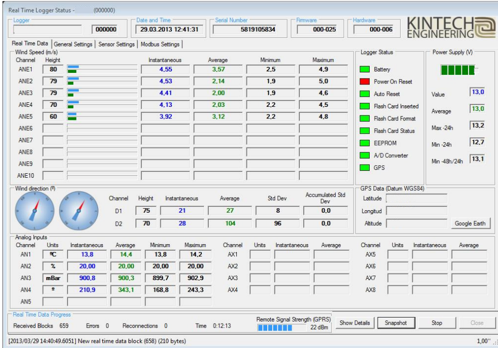
Şekil 5. EOL Zenith veri kaydediciye uzaktan bağlantı arayüzü
