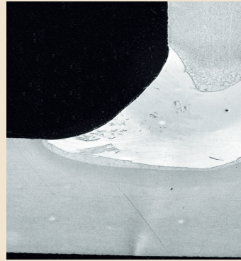
Şekil 4. Köşe kaynağı en kesiti. Ana malzemedeki parlak geçiş dikkat çekmektedir. Kaynak verisi: Lazer gücü 1.0 kW Kaynak akımı: 284 A Ark gerilimi: 27.5 Volt Kaynak hızı: 25 mm/san.
