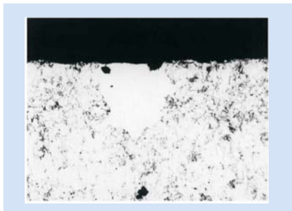
Şekil 17. Bakır Nüfuziyetinin Mikroyapısı
