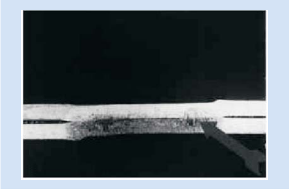
Şekil 2. Halka Kaynağının Mikroyapısı
