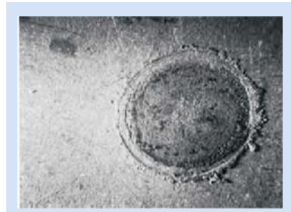
Şekil 11. Saclar Ayrıldıktan Sonra Çinko Bağının Görünümü
