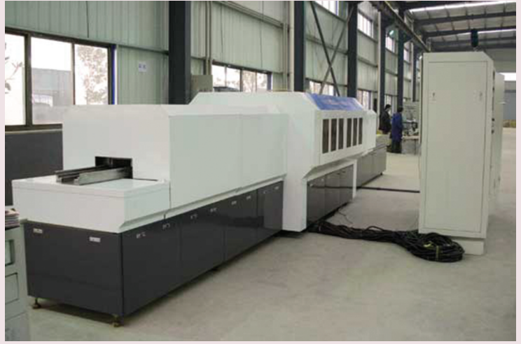
Mikrodalga fırınlar seramik ve metallerin sinterlenmesini hızlandırmaktadır.
