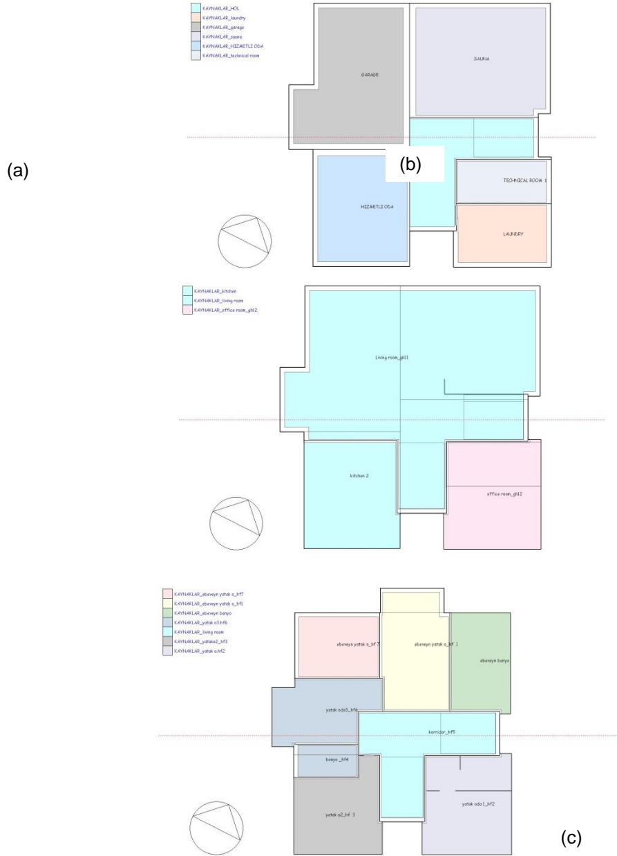
Şekil 6. Dijital modelde bodrum kat (a), zemin kat (b) ve birinci kata (c) ait termal bölgeler (not: her renk ayrı bir termal bölgeyi temsil etmektedir).
