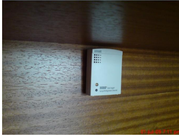
Şekil 4. Kuru termometre sıcaklığı, bağıl nem ve aydınlık seviyesini ölçen veri kayıt cihazı.
