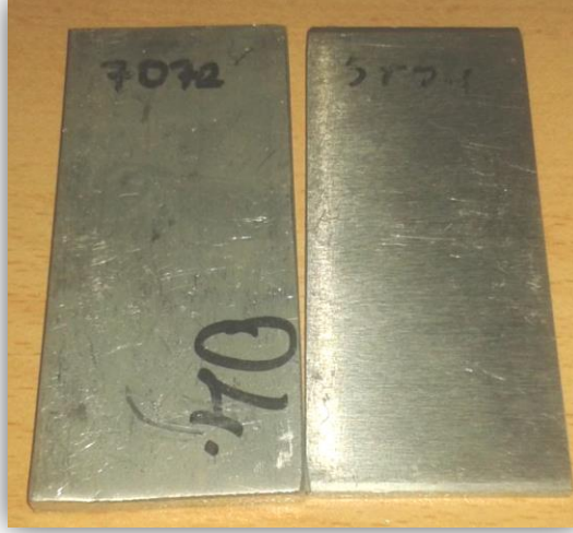
Şekil 2. Kaynaklı Bağlantıları Yapılacak Numuneler
