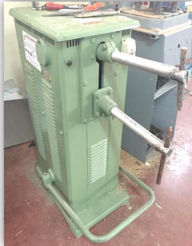
Şekil 5. Deneyde Kullanılan Direnç Nokta Kaynak Makinesi.
