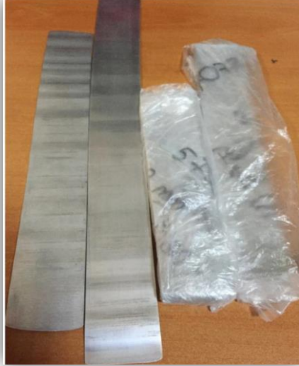
Şekil 3. Kaynaklı Bağlantıları Yapılacak Hadde Sonrası Elde Edilen Numuneler
