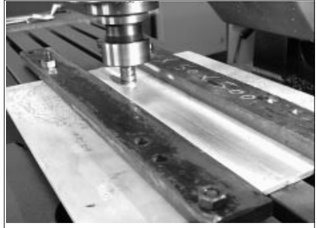
Şekil 1. Sürtünen Eleman ile Birleştirme Kaynağında Parçaların Rijit Olarak Bağlanması ve Kaynak İşleminin Yapılışı (19).
