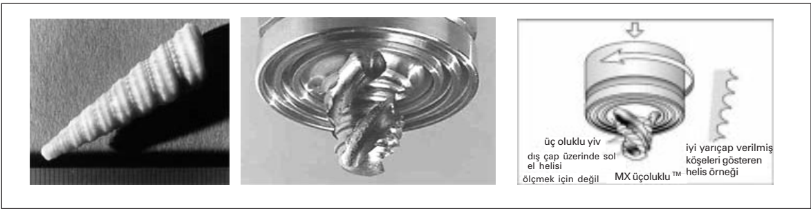
Şekil 5. MX Triflute™ Pimin Esin Kaynağı Deniz Kabuklarıdır. MX Triflute™ Serisi Pimin Resim ve Şematik Çalışma Şekli [13,14].
