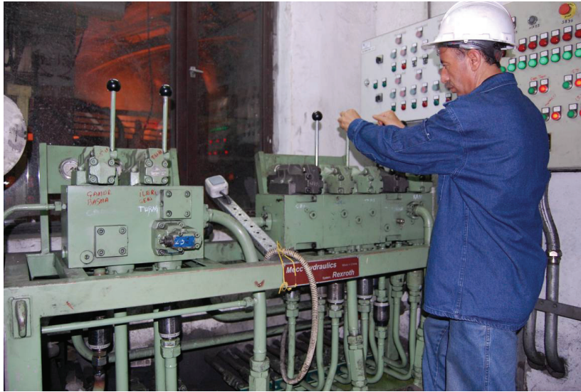
Şekil 15. Çamur Topu Matkap Sisteminde Kullanılan Kol Kumandalı YKV
