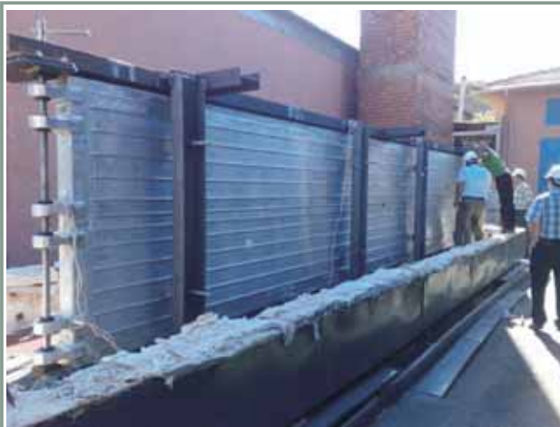
Şekil 5a. Kaynaklı Rampa Kompleksi Suni Yaşlandırma Isıl İşlemi Isıl Çift Yerleşimi
