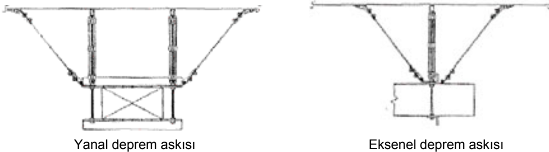
Şekil 1. Asılı kanalların deprem koruması
