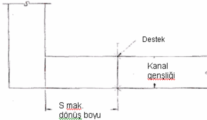
Şekil 4. Dönüş (offset) uzunluğu içindeki yan deprem askısı
