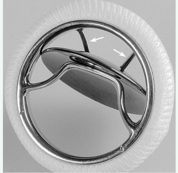
Bjork-Shiley sentetik kalp kapakçığı (üstte) üreticileri, gerilmelerin, diski payandalarla birleştiren bağlantıların (altta) bozulmasına yol açtığını erken fark etmişlerdir.
