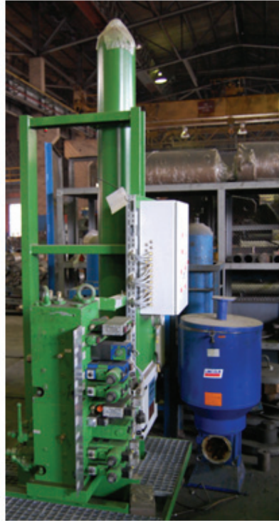
Şekil 10. Akümülatör Uygulaması ve Sembölü
