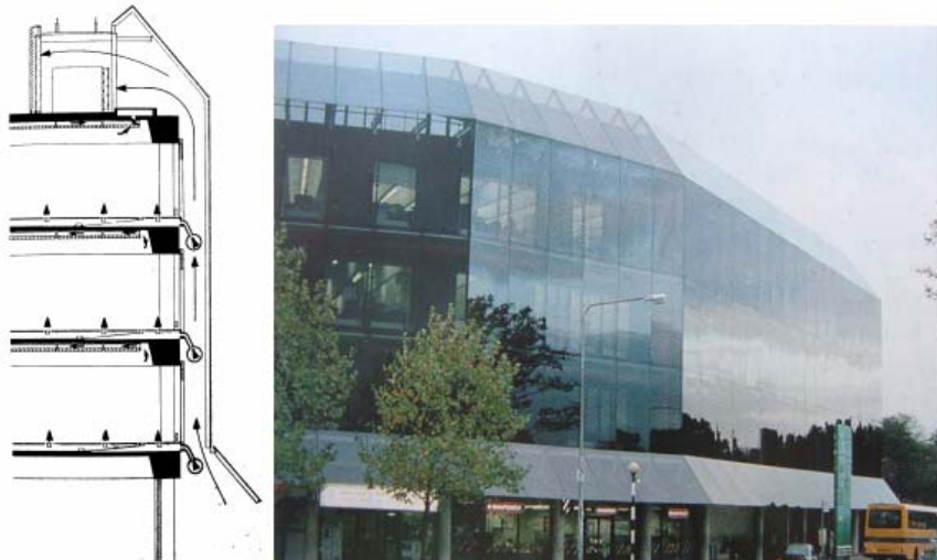
Şekil 6. Mekanik Havalandırılan Cephe Örneği: Briarcliff Evi, Farnborough/İngiltere [16]
