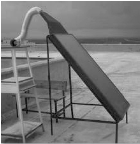
Şekil 2.6 Tasarlanan havalı güneş kollektörünün resimleri
