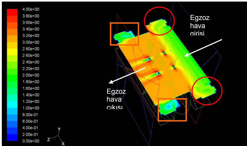
Şekil 45. Döner Isı Değiştirici Hücresi Yatay Düzlemde Hız Dağılımı (Egzoz Havası Bölümü)
