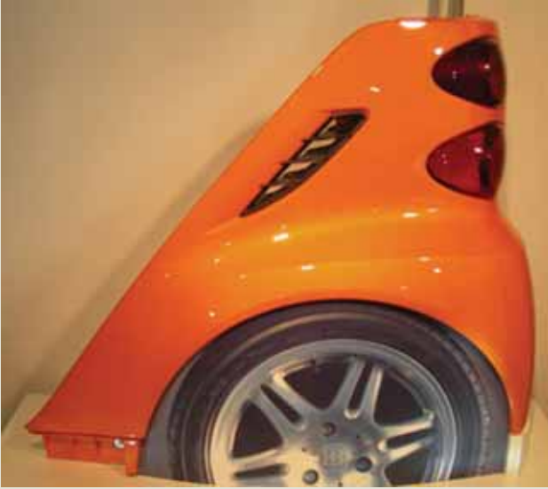
The Fraunhofer Institute for Chemical Technology ICT'teki bilim insanları, bu akıllı arabaya standart araba farları yerine LED stop lambaları yerleştirmişler. Burada esas amaç malzeme ve üretim harcamalarını kısmak. Bu değişikliğin gerçekleştirilmesini de enstitüde geliştirilen yeni yazılım önermiş.
