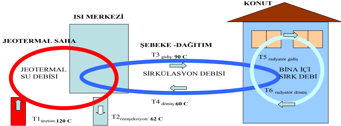
Şekil 4. Bölgesel Isıtma Sistemi Akım Şeması
