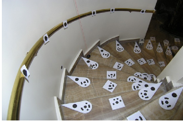
Şekil 4: Merdiven raylarının projelendirilmesi ve kullanılan sensör plaketi
