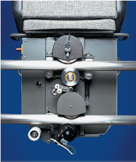
Şekil 5: Tahrik – Motoru Dişli Mekanizması'nın koltuk asansöründe uygulanması.
