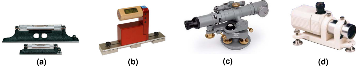
Şekil 1. Küçük açı ölçümü yapan cihazlar (a) Su terazileri [31] (b) Elektronik seviye ölçer [32] (c) Seviye ayarı için kullanılan optik takımlama cihazları – Nivo [33] (d) Otokolimatör [34].
