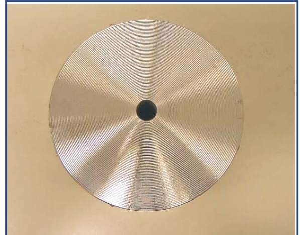
Şekil 7. Alın Tornalanmış Parlak Yüzeyli Periyodik Profile Sahip Alüminyum İş Parçası 1 [15]
