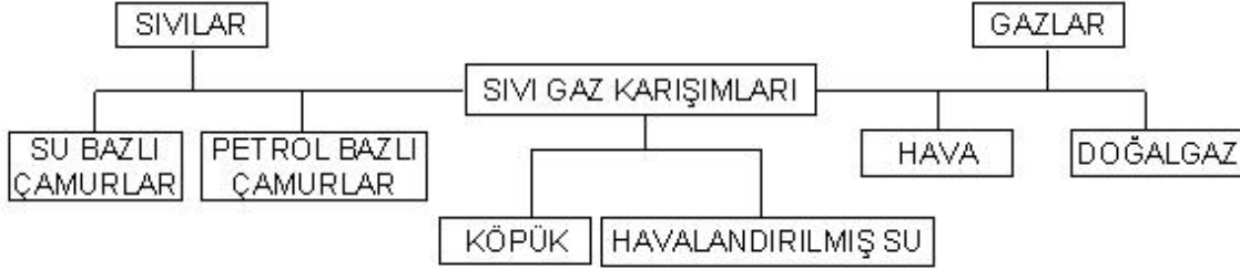
Şekil 15. Sondaj akışkanlarının sınıflandırılması [4]
