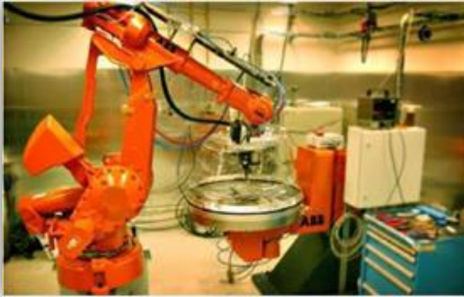
Şekil 6. Soygaz Çevreleme Sistemi
