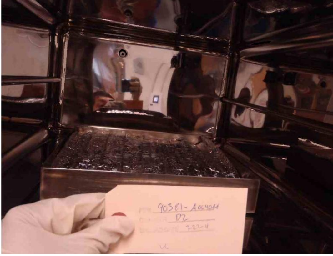
Şekil 2. Ses İzoleli Esnek Hava Kanalının Emisyon Testi [9]
