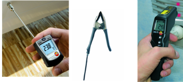
Şekil 4. Boru Yüzeyinden Sıcaklık Ölçümü.
