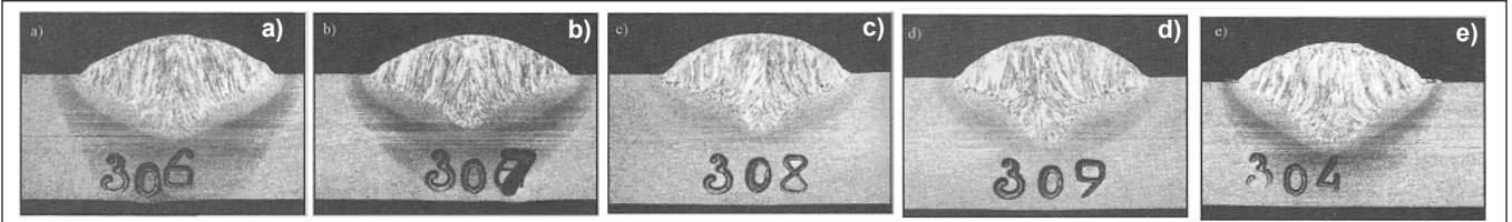
Şekil 17. Koruyucu Gazdaki Argon Oranının Nüfuziyet Şekline Etkisi: a) %20Ar (2,5lt/dk Ar, 9,5lt/dk CO 2 ), b) %25Ar (3lt/dk Ar, 9 lt/dk CO 2 ), c) %29Ar (3,5lt/dk Ar, 8,5lt/dk CO 2 ), d) %33 Ar (4lt/dk Ar, 8 lt/dk CO 2 ), e) %100 CO 2 [10]
