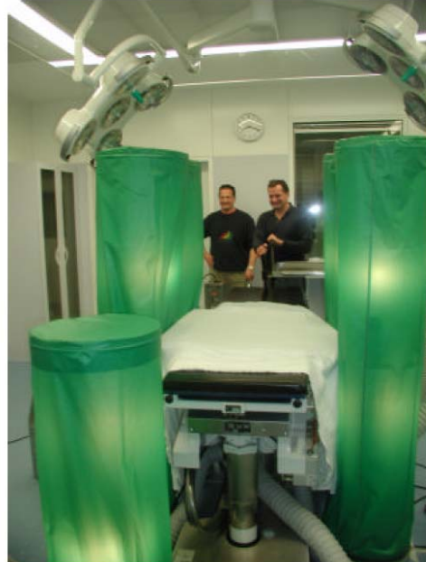
Şekil 7. Ameliyathanelerin Değerlendirmesi İçin Standard Yükleme ve Test Düzenliği
