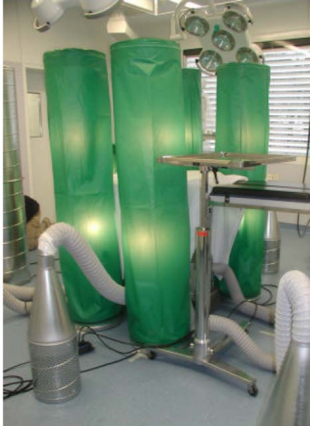
Şekil 7. Ameliyathanelerin Değerlendirmesi İçin Standard Yükleme ve Test Düzenliği
