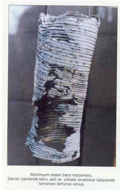
Şekil 49. Bacalı Cihazların Bağlantılarında Alüminyum Fleks Bağlantılardan Kaçınılmalı Yerine Çelik Malzemeler Tercih Edilmelidir.
