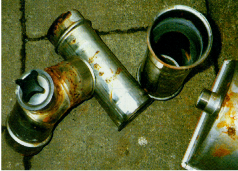
Şekil 71. Mevcut Sorun: Paslanma
