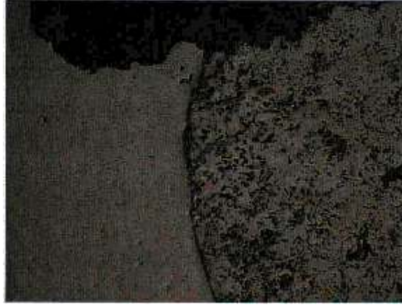
Şekil 2. Demir-Bronz T/M Malzeme Çiftinin Kaynak Dikişinin Görünüşü (x100)
