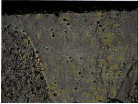
Şekil 3. Demir-Bronz T/M Malzeme Çiftinin Kaynağındaki Boşluklar (x50)
