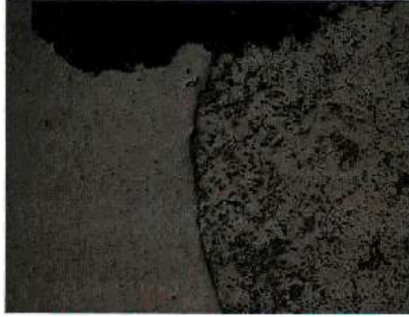
Şekil 4. Demir- Bronz Çiftinin Kaynak Bölgesinin Üst Kısımında Ergime ve Katlaşmadan Kaynaklanan Anormal Yüzey Morfolojisi (x50)
