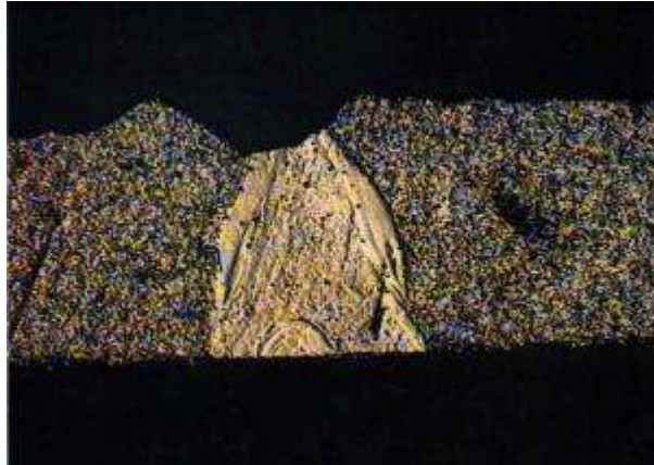
Şekil 5. Bronz- Bronz Çifti T/M Parçaların Kaynak Bölgesi (x15)
