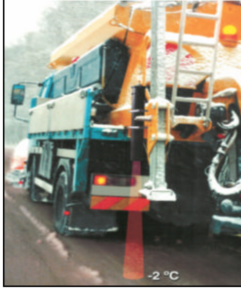
Resim 7. Termolojik sistemin araç üzerindeki montajı.
