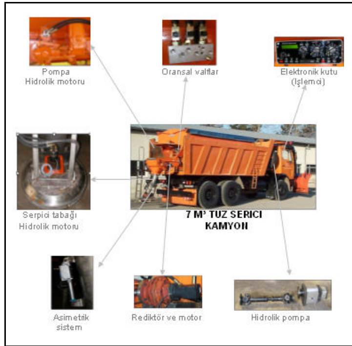
Resim 5. Tuz serici üzerinde yapılan tadilatlar
