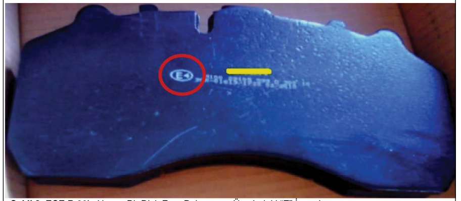
Şekil 3. ECE R 90'a Uygun Bir Disk Fren Balatası ve Üzerindeki "E" İşareti
