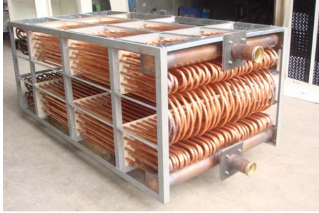
Şekil 15. Su Püskürtmeli Isı Değişiricisi Görünümü (YTO Türkoğlu Makine Sanayi ve Tic Ltd. Şti, İzmir)
