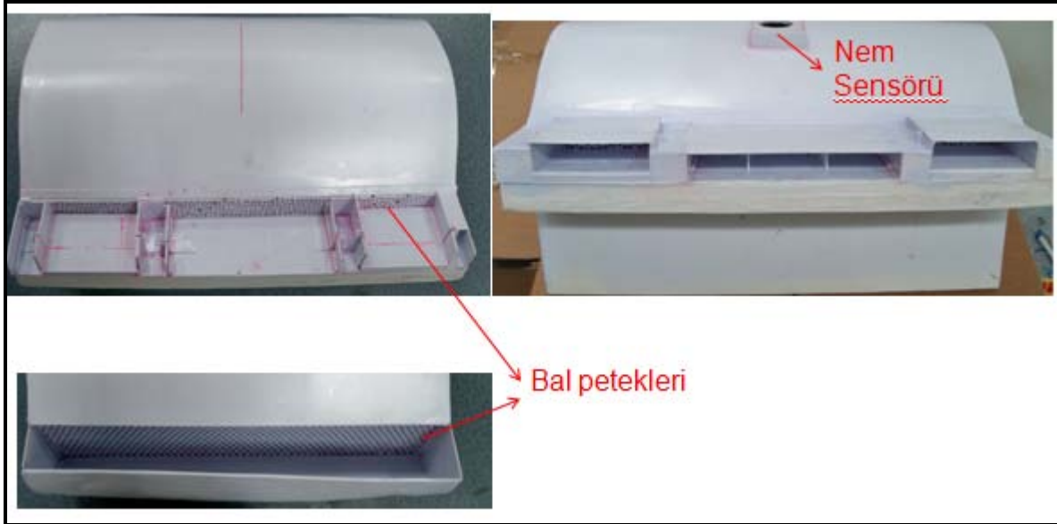
Şekil 8. Sıcaklık ve Basınç Düşümü Ölçüm Noktaları
