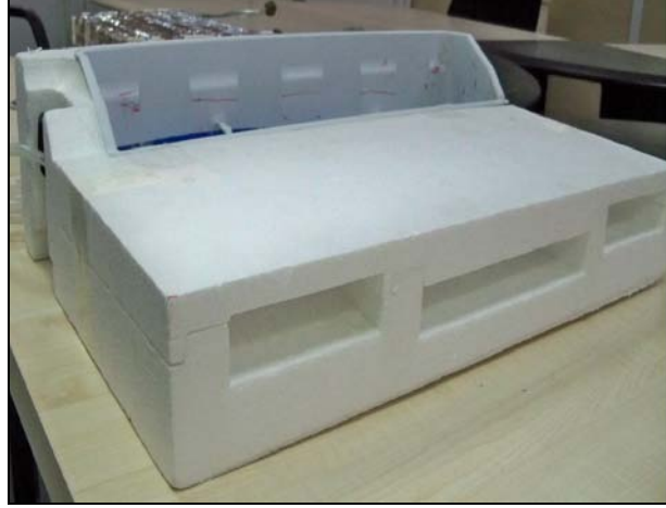
Şekil 5. Ara Bölme Straforu ve Su Oluğu
