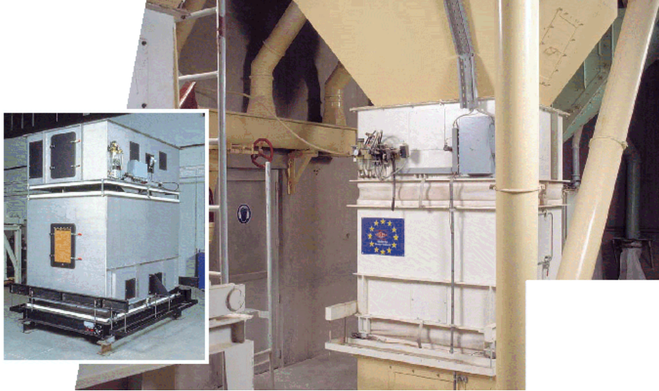
Şekil 4. Precia-Molen firmasına ait ABS-XL kodlu OIML R107 kapsamında bir cihaz
