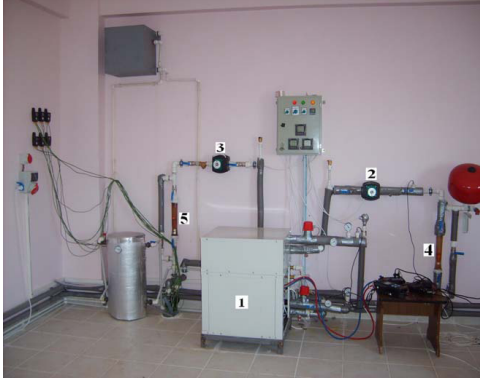
Şekil 2: Isı pompası sistemi elemanları.
