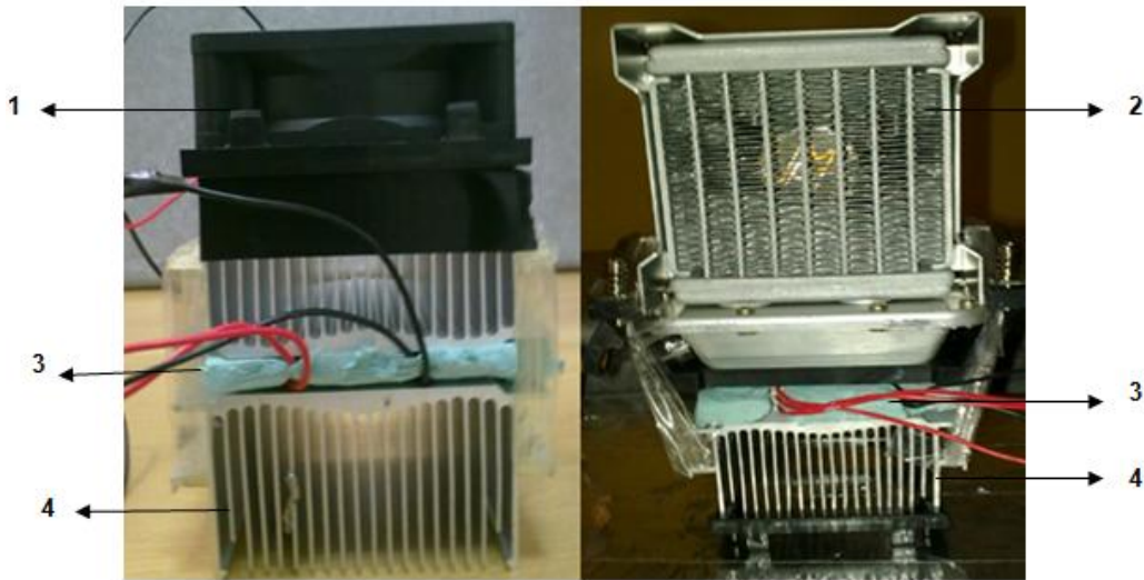
1.12 Voltluk 7H54A-R1 model fan, 2. Xigmatek (Sulu) Fan 3. Termoelektrik Modül, 4. Alüminyum Isı Eşanjörü (Heat-Cold)
