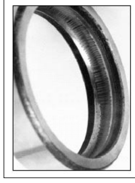
Şekil 26. Elektrik Akımı Geçişinden Kaynaklanan Fluting Arıza Örneği
