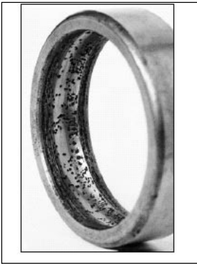
Şekil 25. Dış Bilezikte Nemden Kaynaklanan Korozyon Örneği
