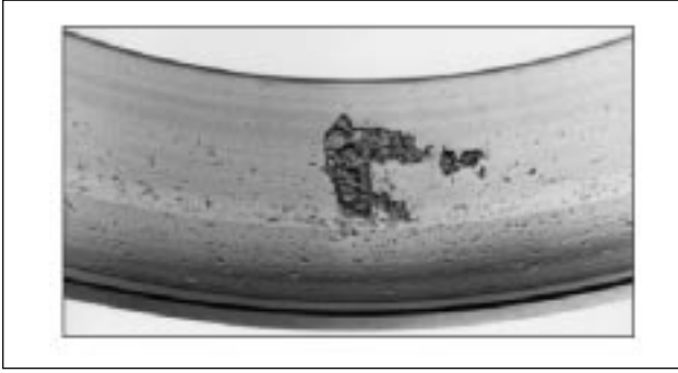
Şekil 24. Rulman Dış Bilezik Fatik Arızası Örneği
