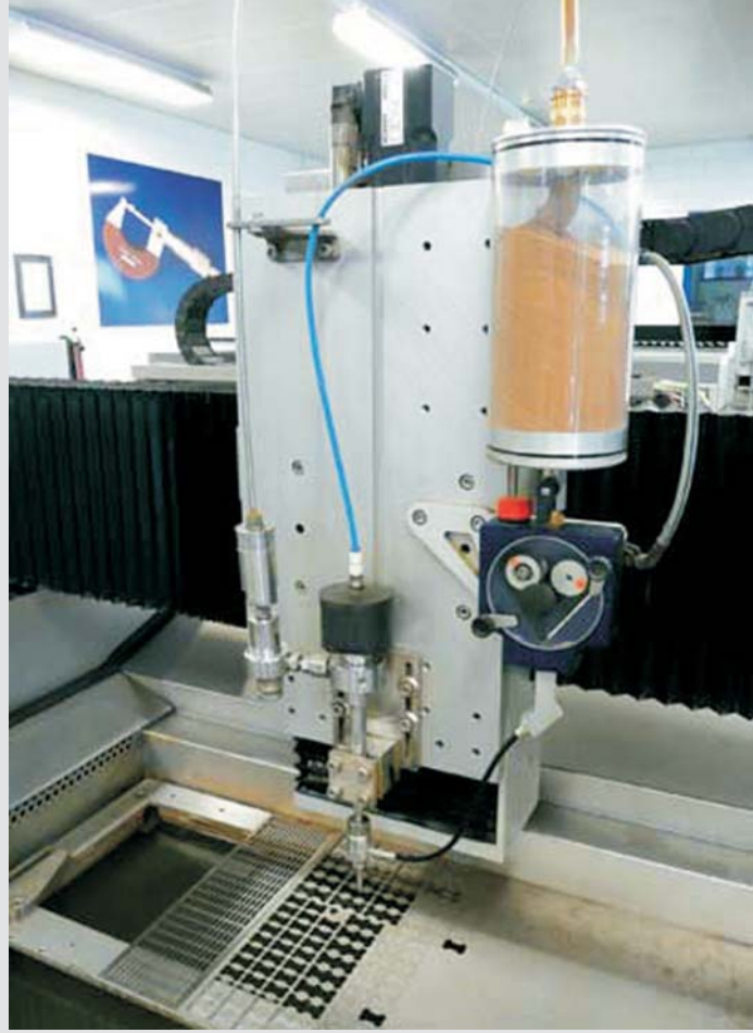
Bir grup hassas makina üreticisi firmanın ortak çabaları ile üretilmiş olan Microwaterjet, artı eksi 1 mikrometrelilik konumlandırma hassasiyetine sahiptir.
