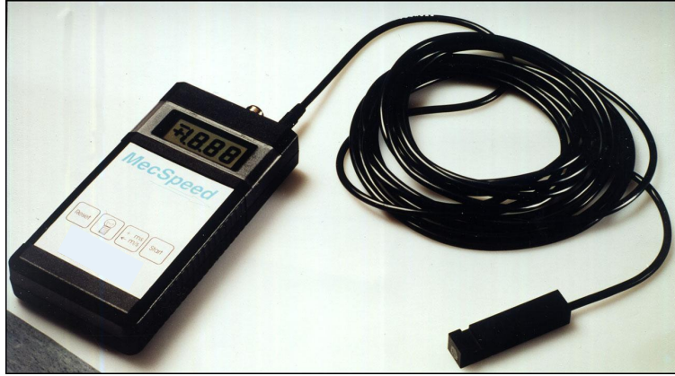
Şekil. 27 Piston hızı ölçüm ve kayıt cihazı
